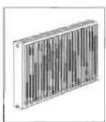
21 HB réversible Épaisseur 72 mm. Assemblage de deux panneaux : un équipé d'une rangée d'ailettes et un sans ailette. Tablette décorative et joues latérales montées en usine. Chaleur diffusée par convection et rayonnement.
