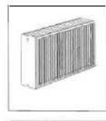
22 HB réversible Assemblage de deux panneaux avec ailettes. Épaisseur 101 mm. Tablette décorative et joues latérales montées en usine. Chaleur diffusée par convection et rayonnement.
